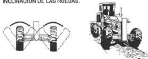
Figura N° 101 Inclinação de las ruedas delanteras
