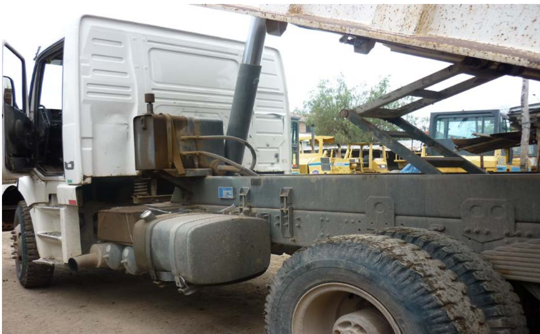
Figura N° 01 Volquete Volvo sistema de volteo
