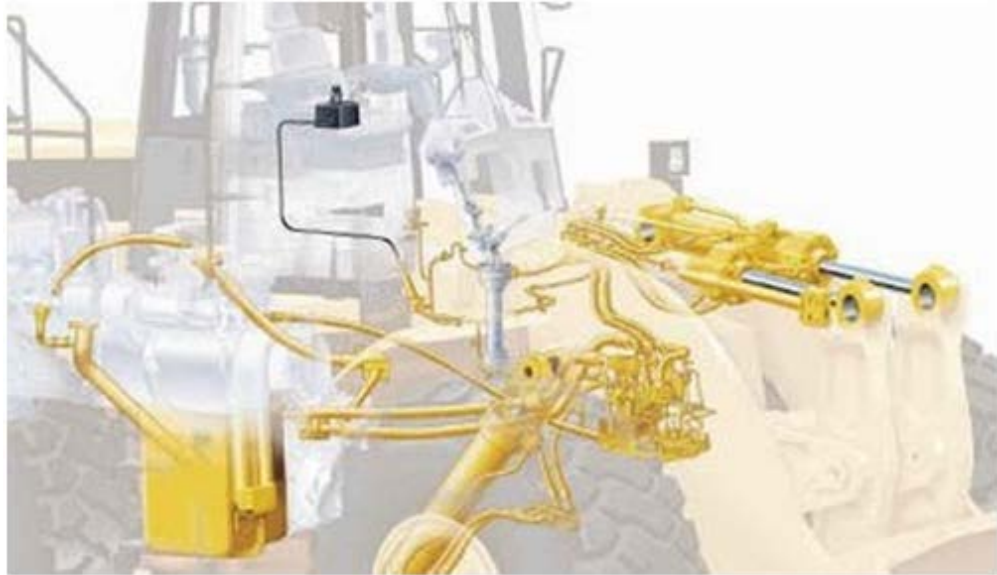
Figura N° 89 Sistema Hidráulico de cargador frontal
