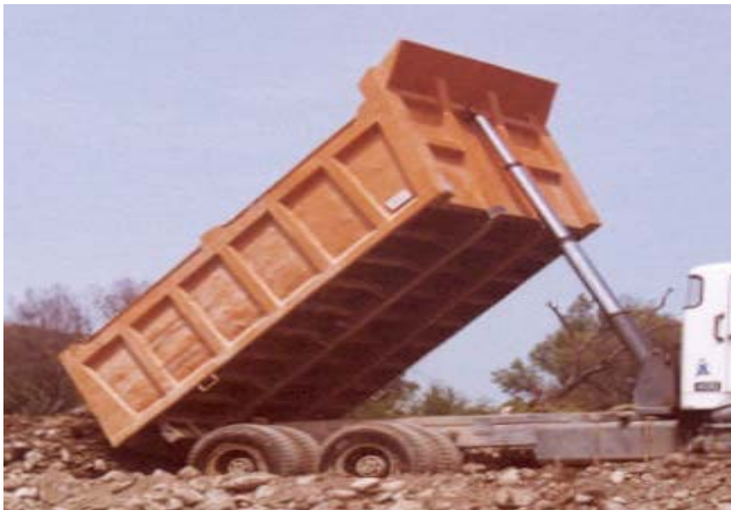
Figura N° 65 Tolva metálica y botella hidraulica
