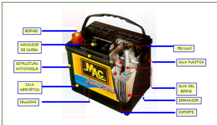
Figura N° 51 Partes de una Batería
