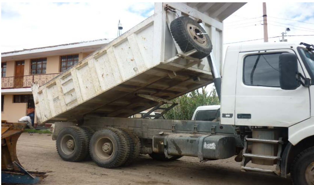
Figura N° 01 Volquete Volvo sistema de volteo
