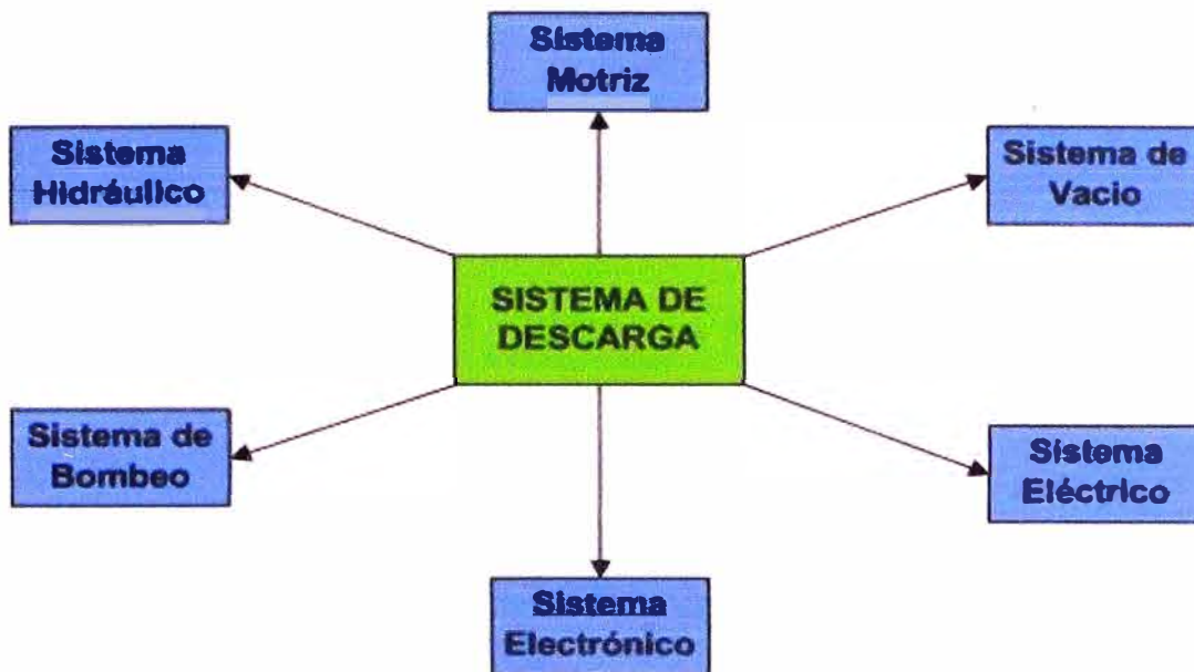
Fig. 5.2 Subsistemas del Sistema de Descarga
