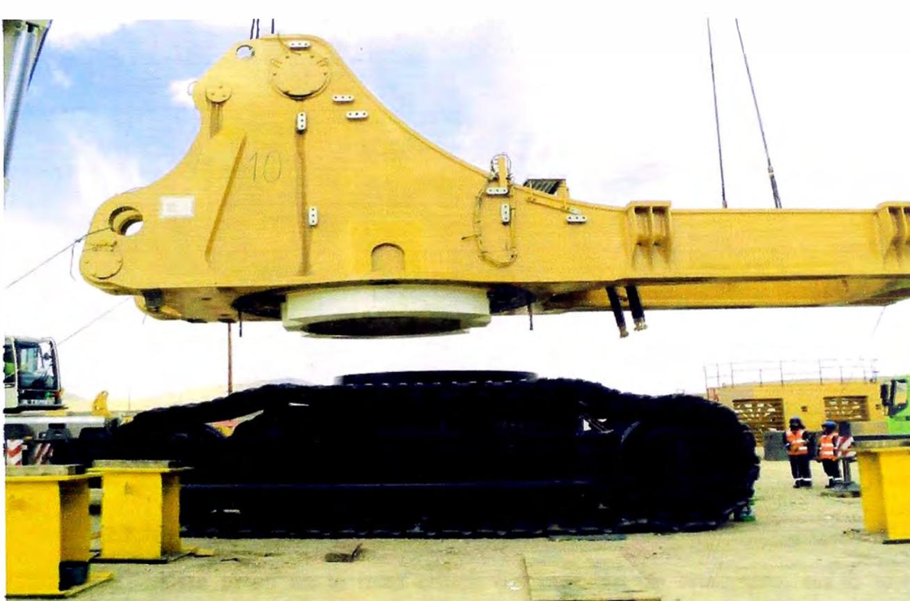
Fig. 4.4 Montaje de estructura superior
