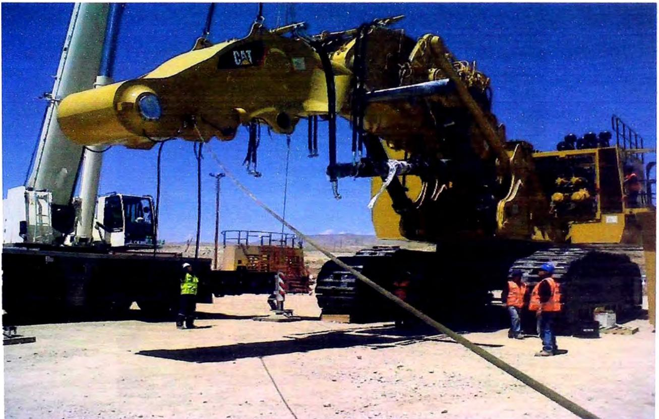
Fig. 4.10 Montaje del Stick o mango
