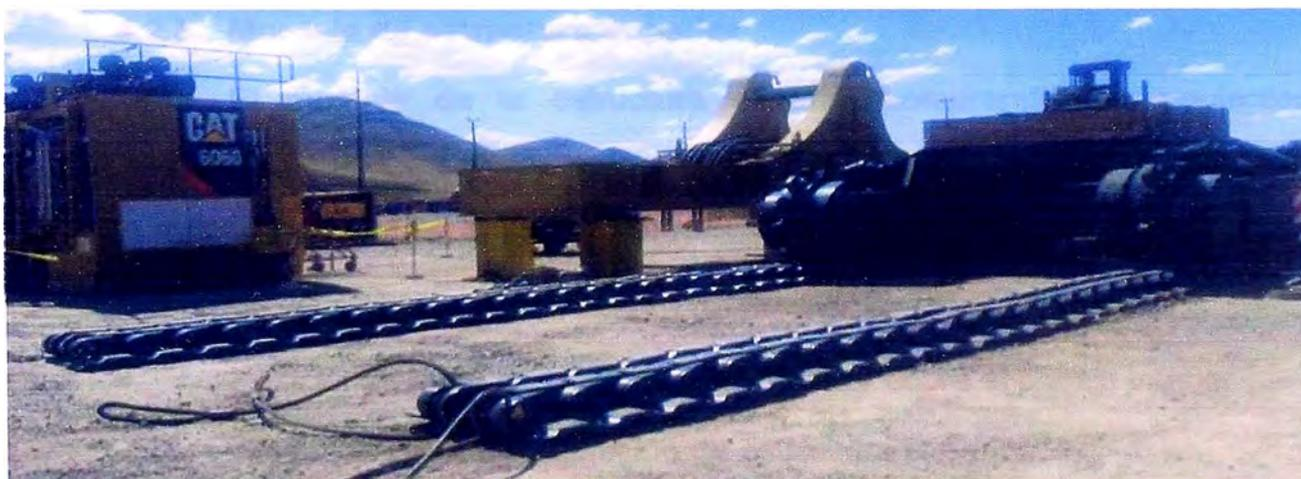
Fig. 4.2 Unión y posicionamiento de cadenas de orugas
