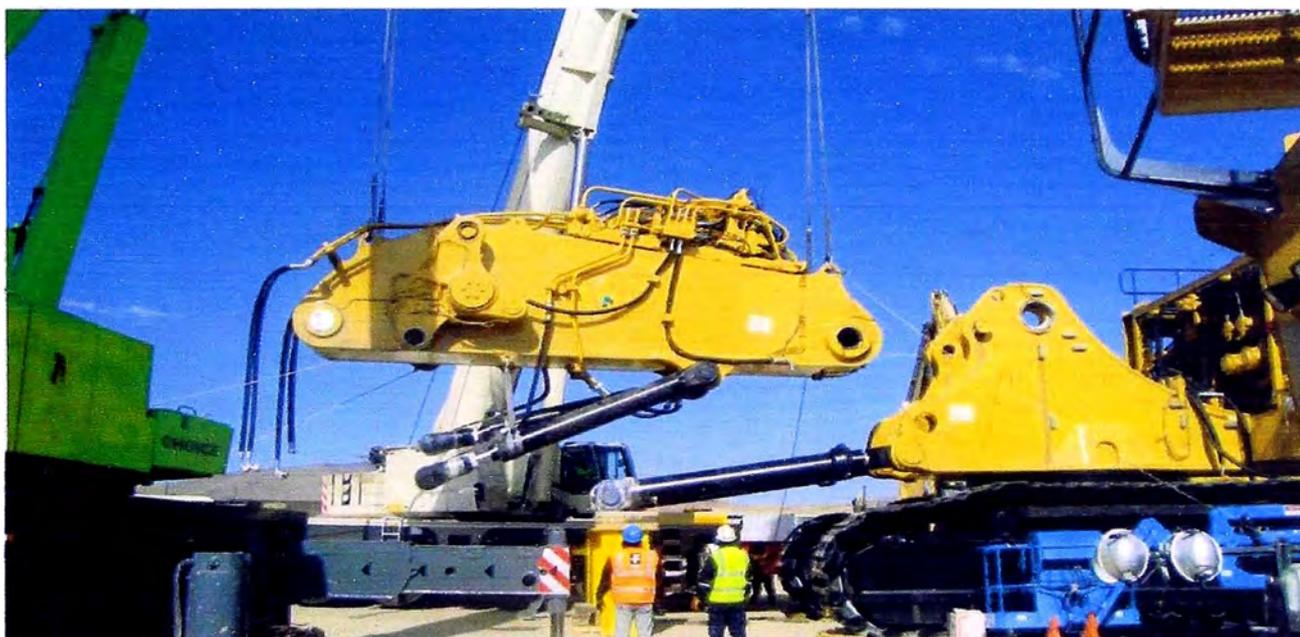
Fig. 4.6 Montaje del boom
