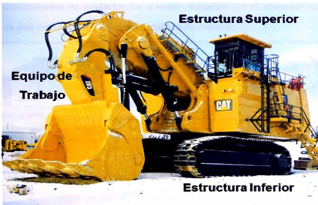
Fig.3.1 Estructuras principales de la Pala 6060FS
