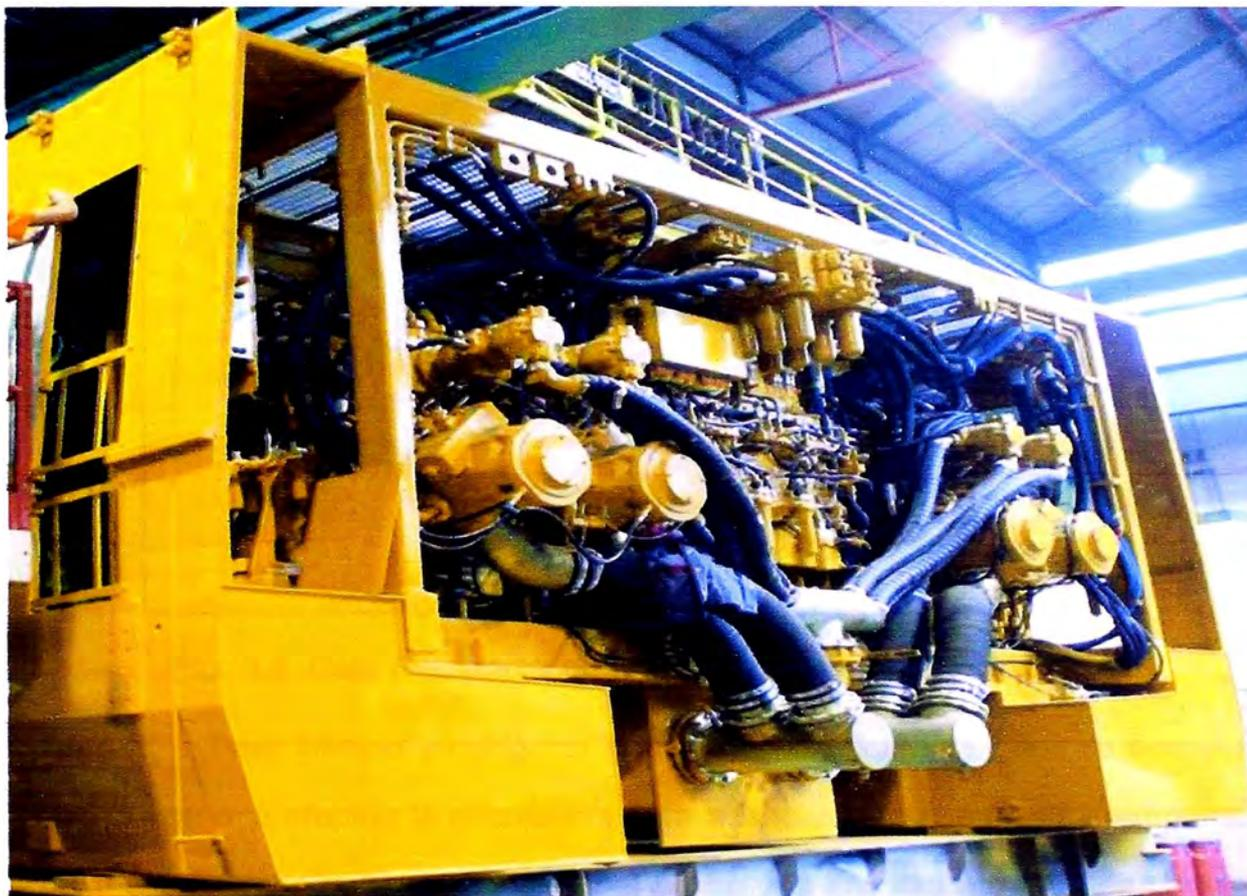
**Fig. 3.4 Módulo de motores, contiene 02 motores CAT modelo 3512C**
