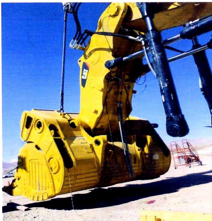
Fig. 4.11 Montaje del Bucket o cucharón.
