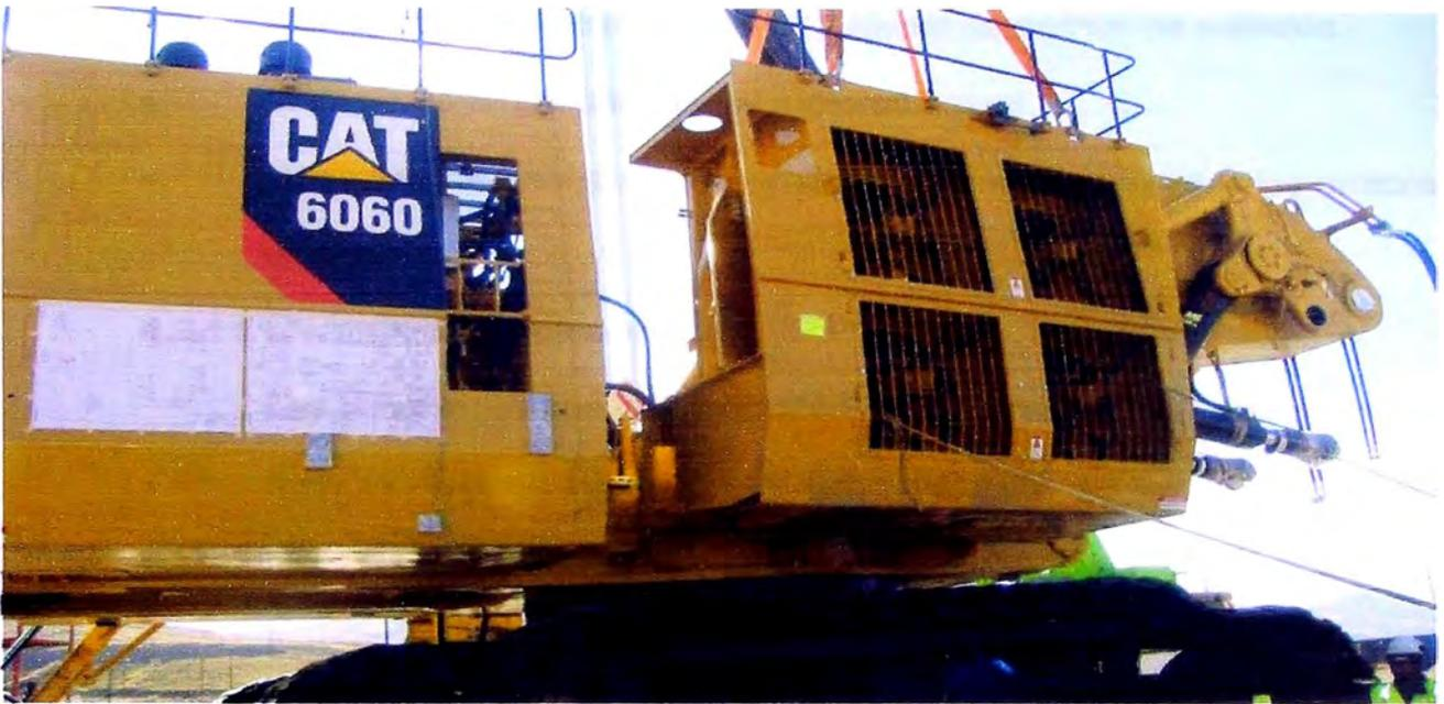
Fig. 4.8 Montaje del módulo enfriador de aceite
