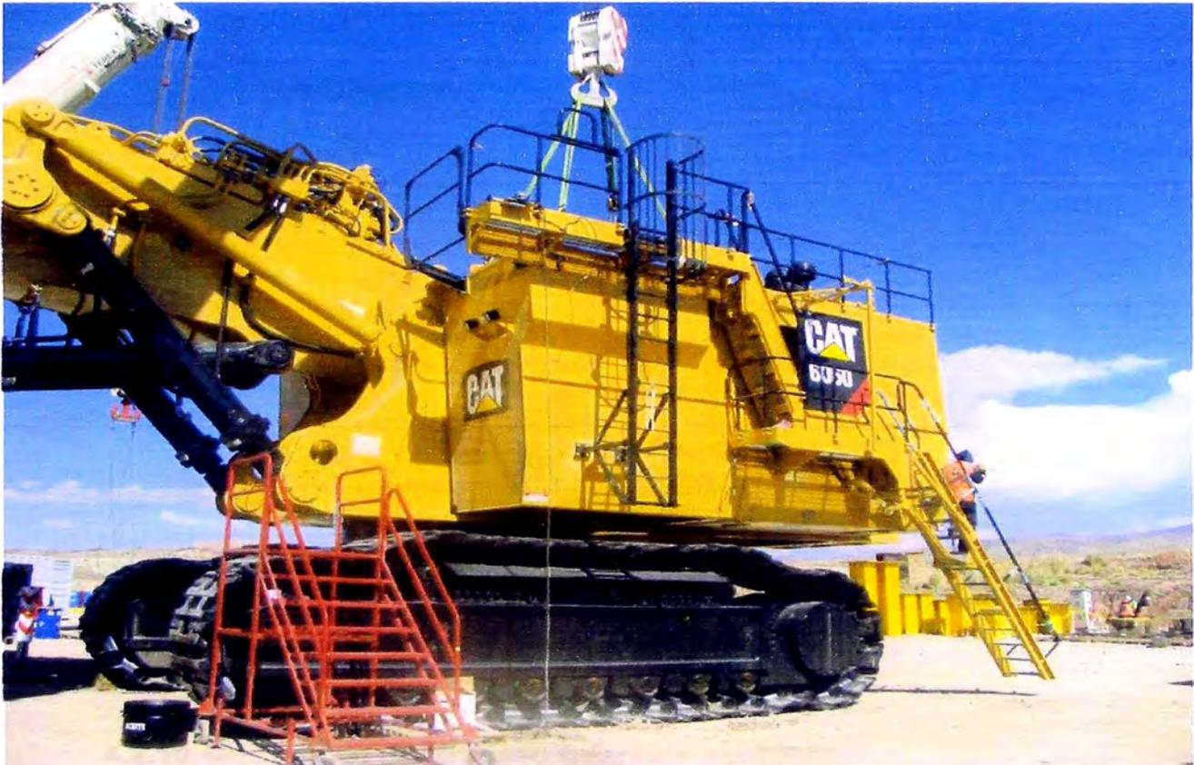
Fig.4.7 Montaje del módulo pedestal de cabina
