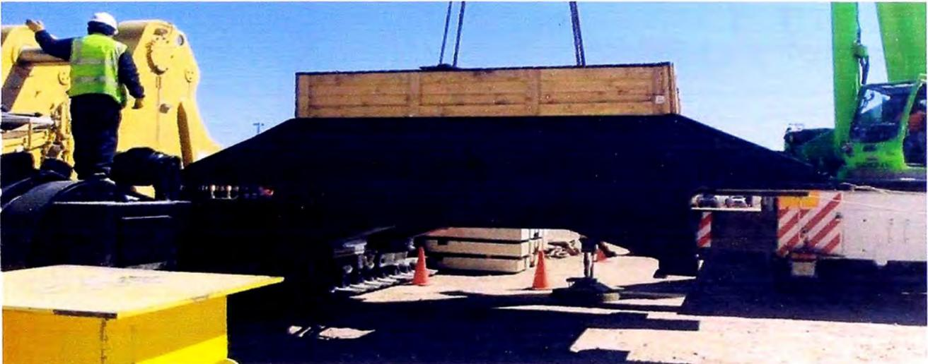
Fig. 4.3 Montaje de chasis inferior sobre bastidor derecho
