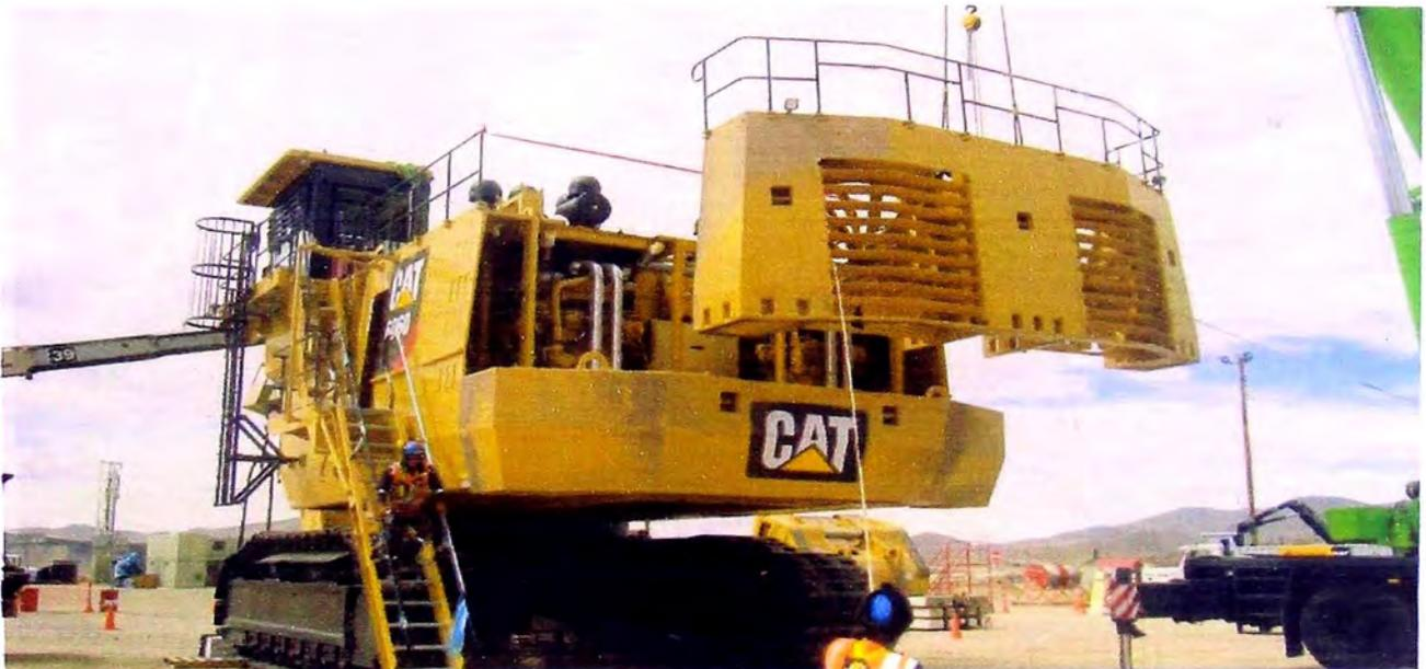
Fig. 4.9 Montaje contrapeso superior
