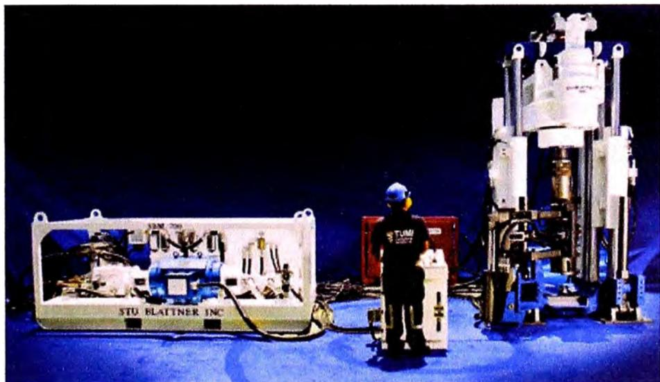
**Fig. 1.1** Sistema de Perforación Raise Boring.
