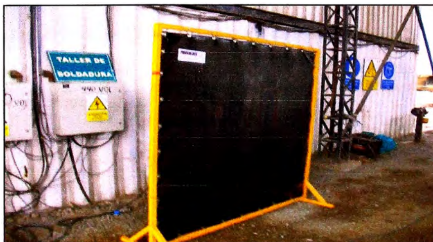
Figura 3.5 – Pantalla portátil para la realización de los trabajos de soldadura
