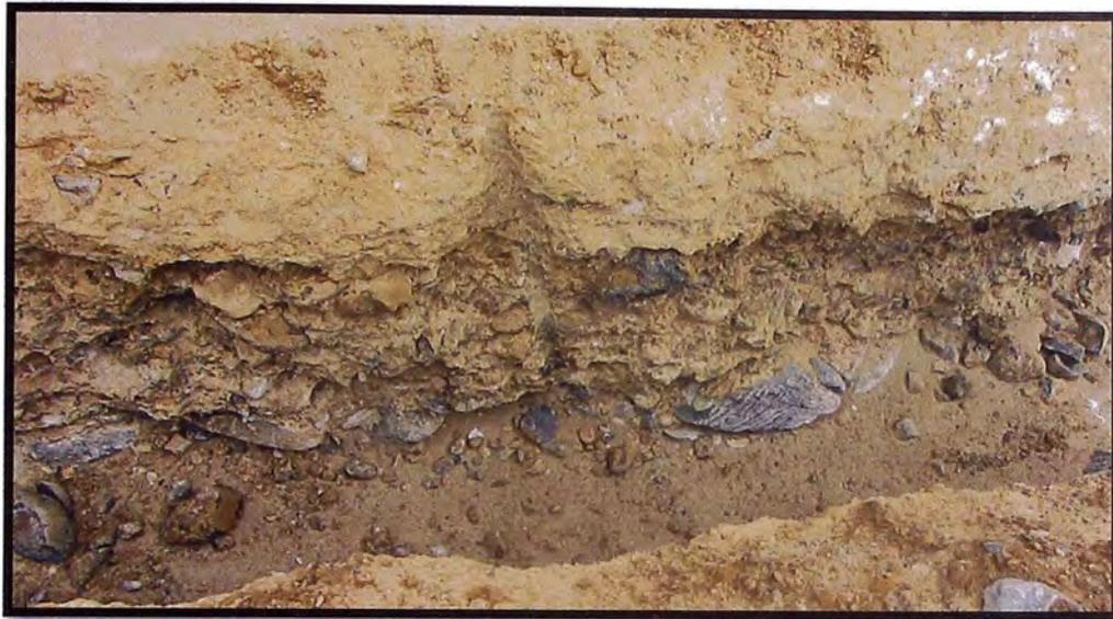
Figura N°26: Pared de zanja excavada con quipo Trencor 1260.
