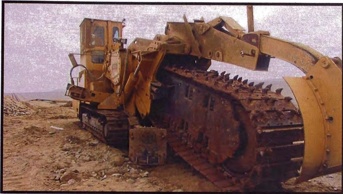
Figura N°19: Zanjadora Trencor 1260.
