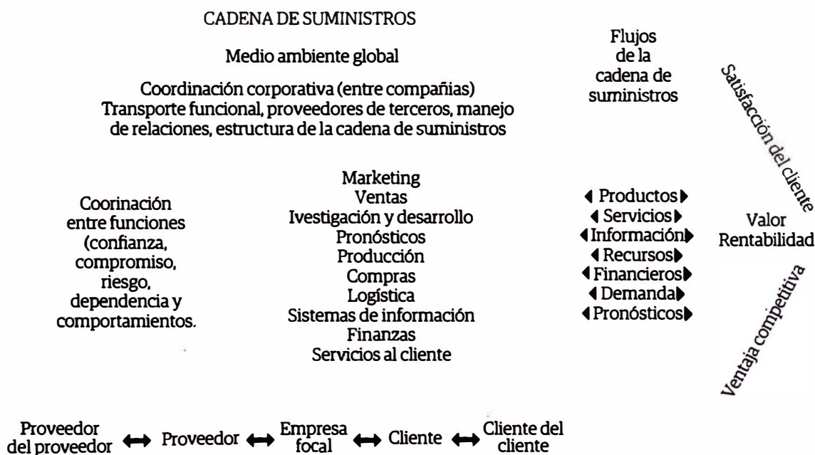
Infografía 11. Modelo de gestión de cadena de suministro Fuente: Mentzer (2001), citado por Ballou (2004, p.6) y Lietke (2005, p. 11).
