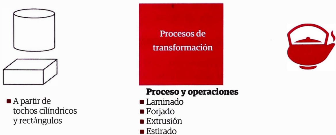
Infografía 3. Proceso de transformación de tochos a tetera de aluminio Elaboración propia
