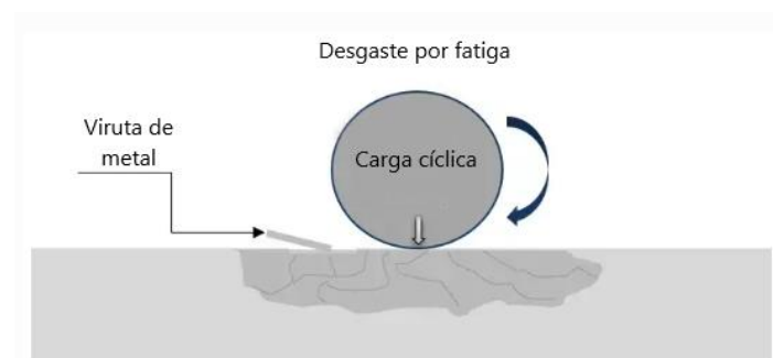
Figura A.3 Desgaste por fatiga
