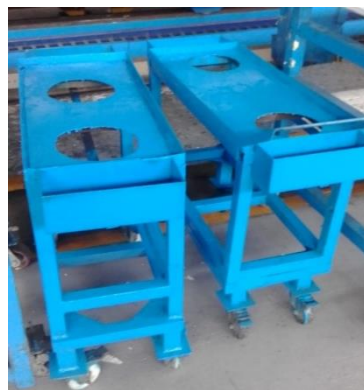
Estructura para Curado de paneles
