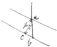
ciamiento. Cuando este esté próximo se disminuirá la amplitud de los golpes para determinar el momento en que se llegue al carbon. Entonces marcando la longitud de la sonda que penetra al taladro se podrá por diferencia con la que tenga cuando haya pasado el carbon, obtener la medida deseada.
